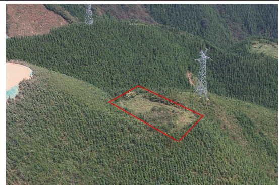
1#堆料场及牵张场撒播草籽绿化
